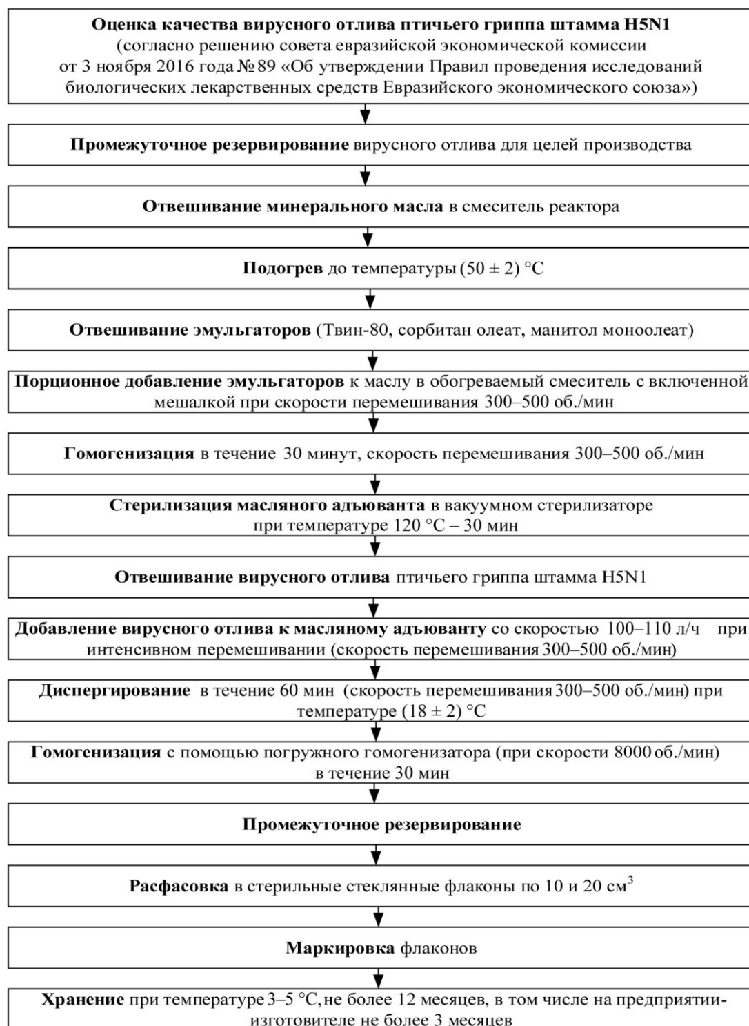
Рисунок 5 – Процессуальная схема производства вакцины от птичьего гриппа
